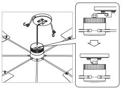
ナットが台座に水平 にのるようにします。
